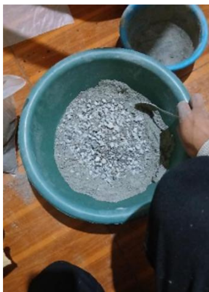
Figura 1. Mezclado de materiales sólidos en la mezcla de hormigón.
