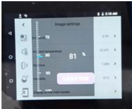
Figura 8. Configuración de la humedad relativa en la Cámara termográfica
