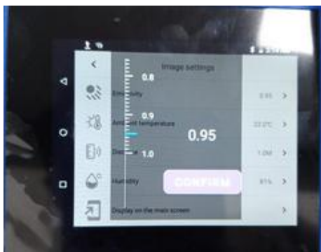
Figura 5. Configuración de la emisividad en la Cámara termográfica
