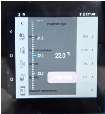
Figura 6. Configuración de la temperatura ambiente en la Cámara termográfica
