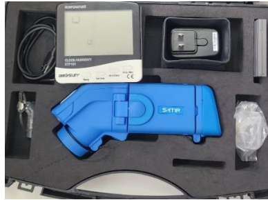
Figura 3. Cámara Termográfica SATYR T256
