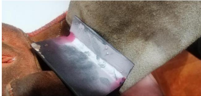
En la figura 2 se indica una probeta 1F el mismo que se realizó con electrodo revestido 6013 con un amperaje de 100, en donde se puede observar que el electrodo 6013 tiene un mejor acabado comparado con la probeta 1, realizada en este caso con electrodo 6011. Después de aplicar las tintas penetrantes se puede destacar que al inicio y al final de la probeta presenta coloración roja indicando que está mal el proceso de soldadura.
