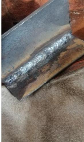
En la probeta N 3 se indica una probeta 1F el mismo que se realizó con electrodo revestido 6011 con un amperaje de 90 amperios ya que el electrodo 6011 comparado con el 6013 es un poco más difícil al soldar y también se tiene un acabado de cordón no muy agradable.
