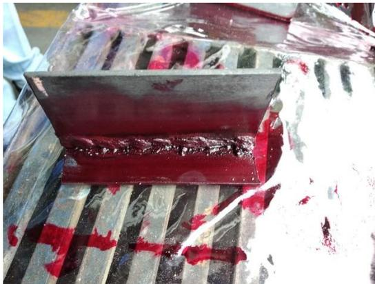
En la figura se indica una probeta 1F el mismo que se realizó con electrodo revestido 6011 con un amperaje de 90, pero con respecto al efecto de las tintas penetrantes no se efecto correctamente debido al que la probeta no se realizó adecuadamente el proceso de quitar la escoria. Debido al efectuar incorrectamente la limpieza de la probeta las tintas penetrantes no se realizó el proceso de supervisión.
