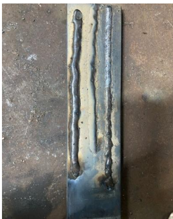
Figura 7. Resultado de la soldadura con escoria
