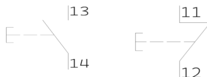
Figura 24.- Representación de pulsador normalmente abierto y normalmente cerrado
