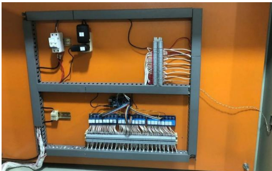
Figura 6. Parte interna del módulo didáctico simulador de protecciones en configuración de doble barra con bypass
