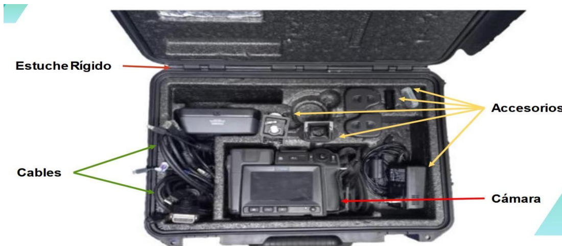
Figura 2: Reconocimiento de cámara termográfica
