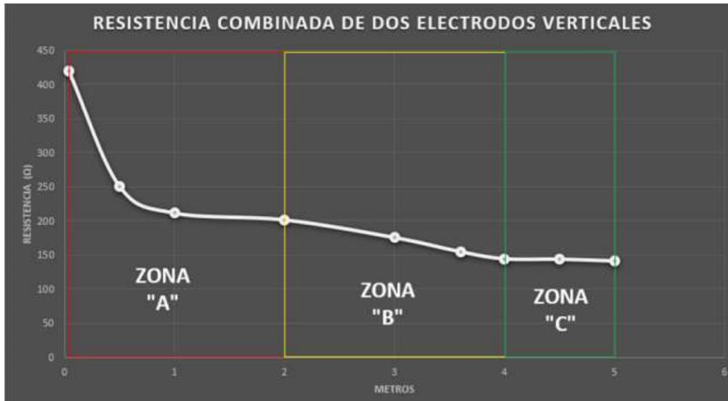
**Nota:** ilustración presentada de la distancia entre electrodo en metros vs la resistencia de la puesta a tierra. **Elaborado por:** Grupo Investigador
