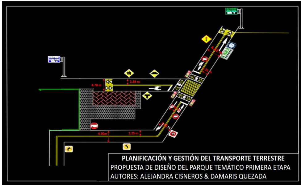
**Figura 4 :** *Diseño de la primera etapa de implementación del parque temático y práctico de transporte, tránsito y seguridad vial*
