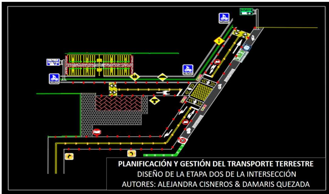
**Figura 10:** Diseño de la segunda etapa de la intersección del parque temático y práctico de la carrera
