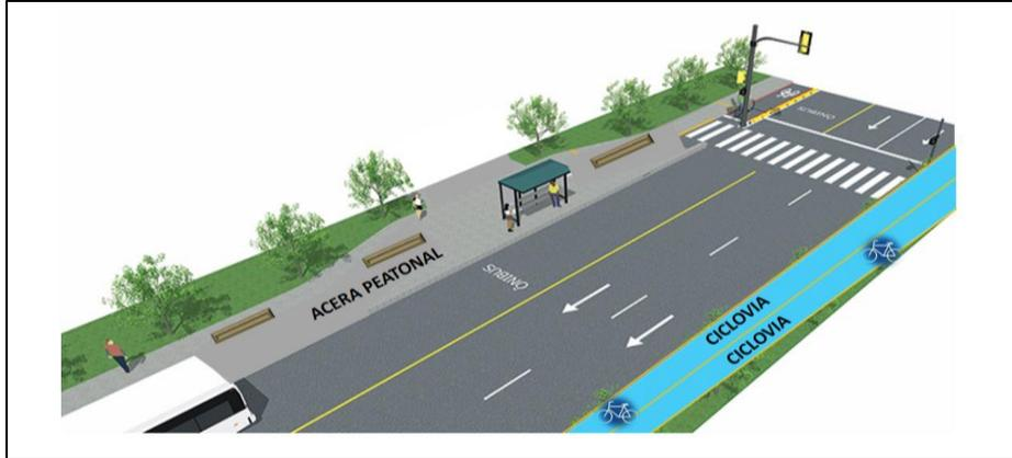
**Figura 8:** Diseño de la intersección con acera peatonal y ciclovía
