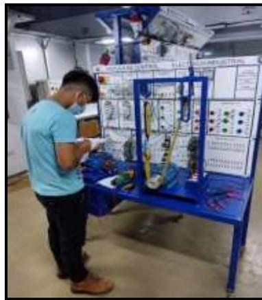
Nota. Comprobación del correcto cableado de los elementos, mediante una amperimétrica.
