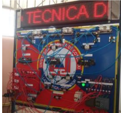
Figura 2. Implementación de circuitos neumáticos en el módulo didáctico
