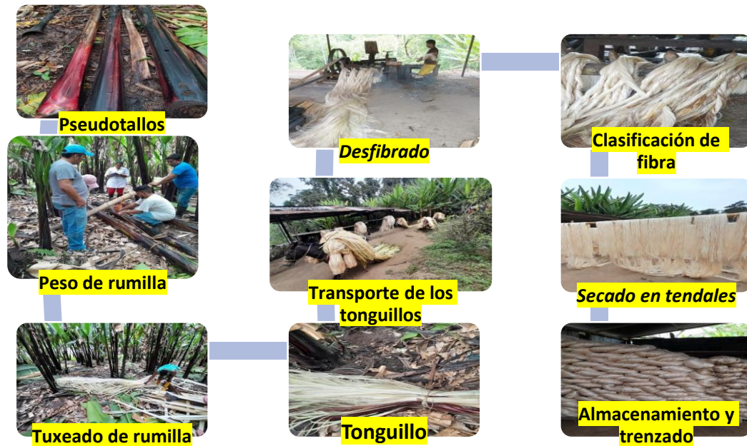
Figura 1. Diagrama del Proceso para la Obtención de Fibra de Musa textilis
