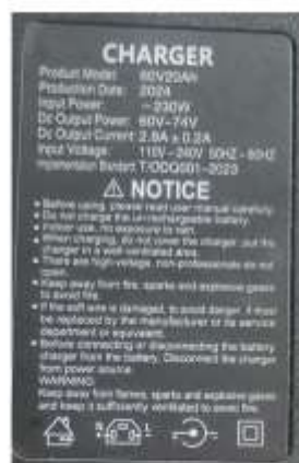
Figura 4. Componentes eléctricos principales: controlador electrónico y etiqueta del cargador de 60–74 V y 2,8 A.
