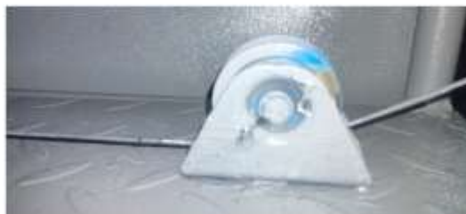
Figura 6. Sistema de transmisión de la rampa: (a) disposición del cable de acero; (b) detalle de la polea.
